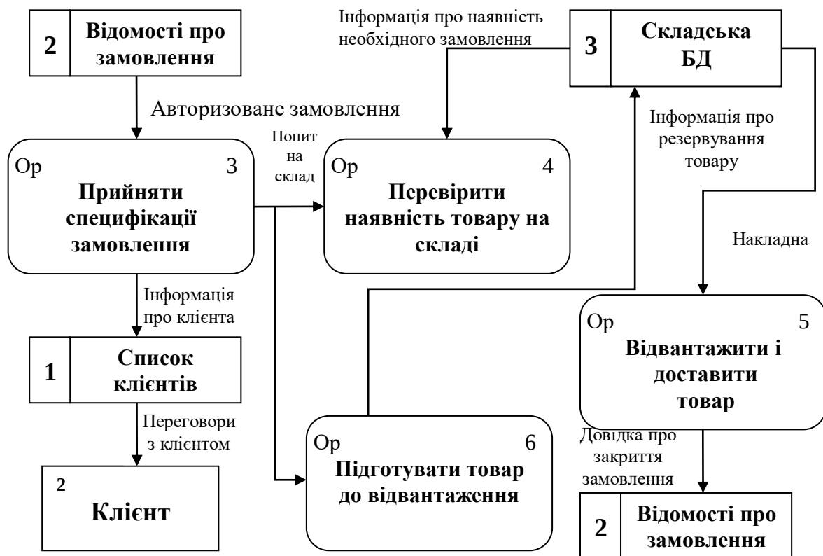
Рис. 3.13. Приклад діаграми DFD бізнес-процесу «Обробка замовлення»
