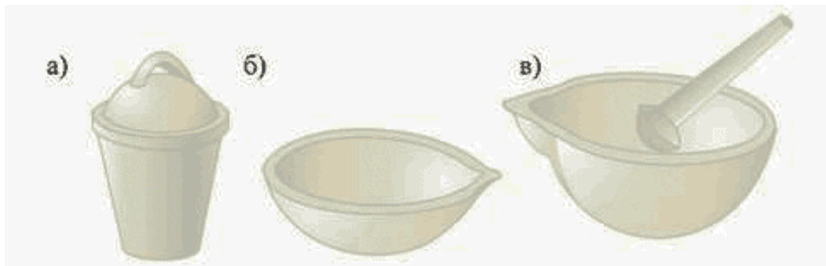
Рис. 5. Фарфоровий посуд: а) тигель; б) чашка; в) ступка з товкачиком
