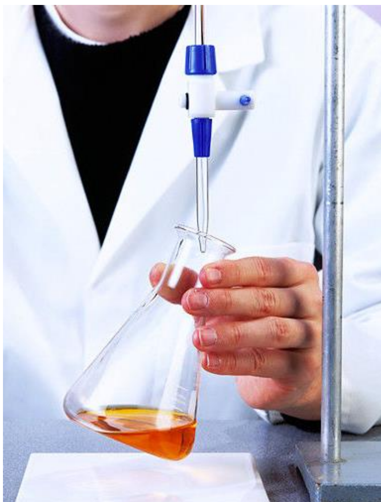
Рис. 20. Процес титрування: правильне розміщення конічної колби, розташування носика бюретки
