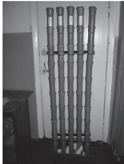
Рис. 2. Труби, заповнені ущільненим ґрунтом з позначенням даних вгорі щодо вихідної щільності скелета ґрунту  $\rho_d$  та його заданої вологості  $W$
