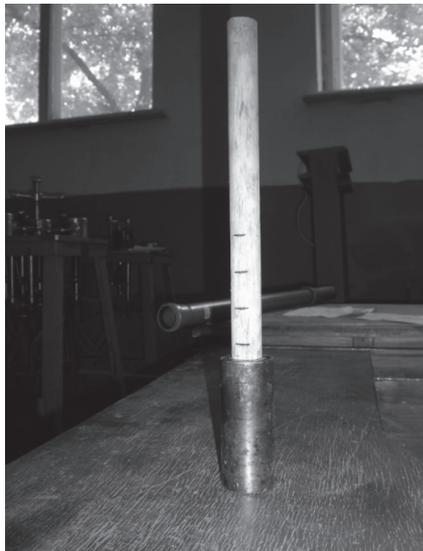
Рис. 1. Ручна трамбівка для ущільнення ґрунту
