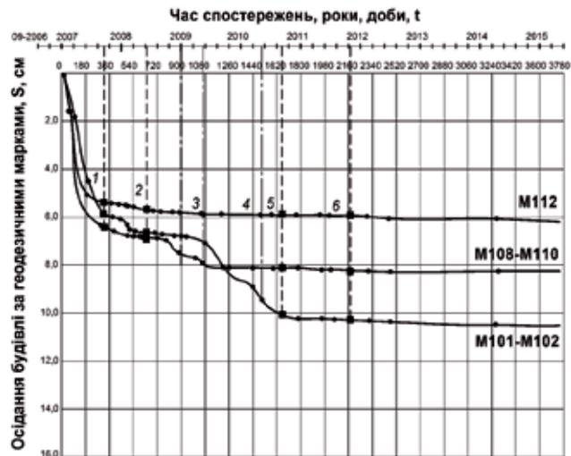
Рис.7. Графіки осідання секції I у часі за стіновими марками з характерними датами:
