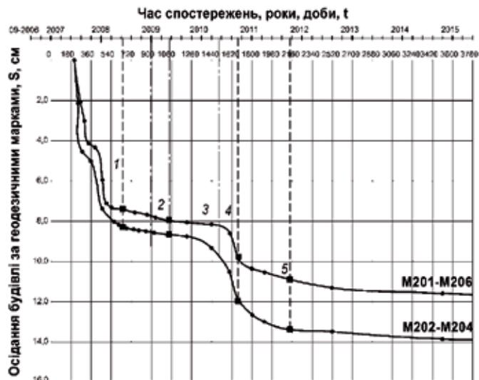
Рис.8. Графіки осідання у часі секції II за стіновими марками з характерними датами: 1 – кінець будівництва секції II; 2 – початок зведення секції III; 3 – початок будівництва секції IV; 4 – кінець зведення секції III; 5 – кінець будівництва секції IV.
