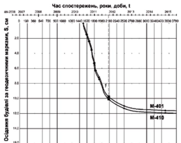
Рис.10. Графіки осідання у часі секції IV за стіновими марками з характерними датами: 1 – завершення будівництва секції I.
