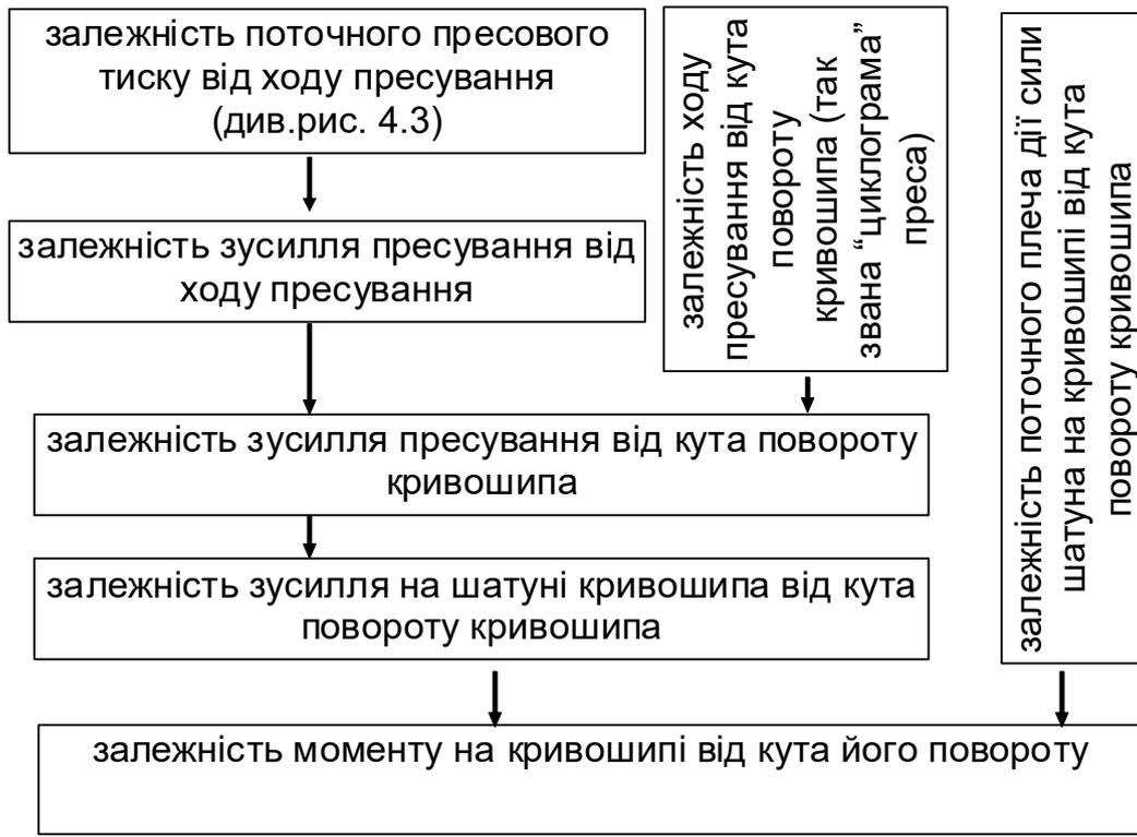
Рисунок 10.32 – Послідовність одержання діаграми моменту крутіння на кривошипі механічного преса від кута повороту кривошипа
