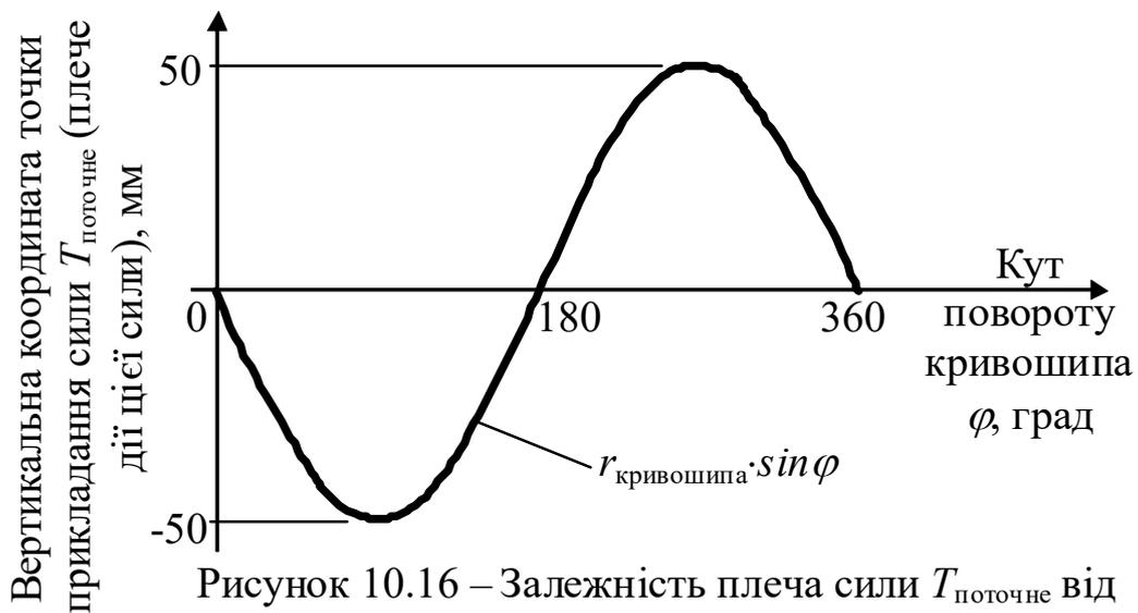
Рисунок 10.16 – Залежність плеча сили  $T_{\text{ПОТОЧНЕ}}$  від кута повороту кривошипа
