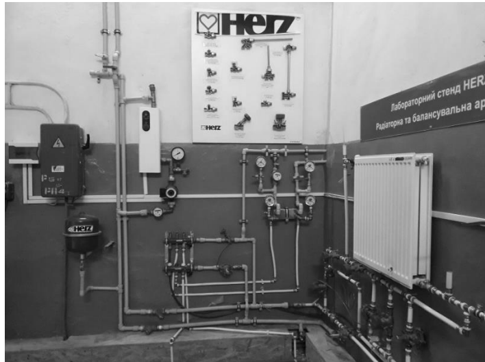
Рис. 1. Зовнішній вигляд частини стенду для теплотехнічних досліджень водо-водяного пластинчатого теплообмінника
