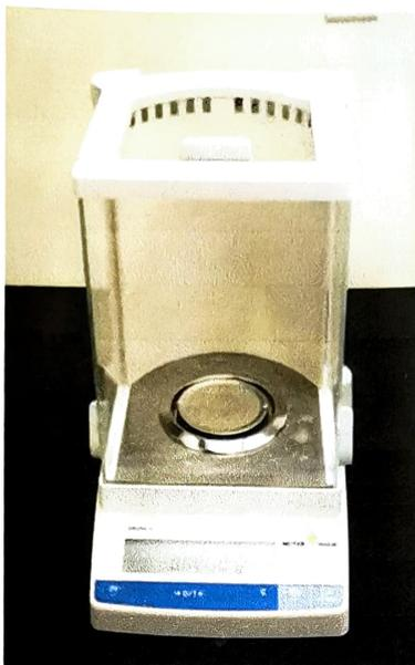
Рис. 2.3. Лабораторні ваги АВ-204-S/FACT (Mettler Toledo, Швейцарія)
