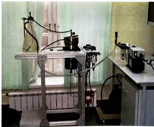
Рис. 2.5. Сатуратор MS-535 (Coretest Systems Corporation, США)
