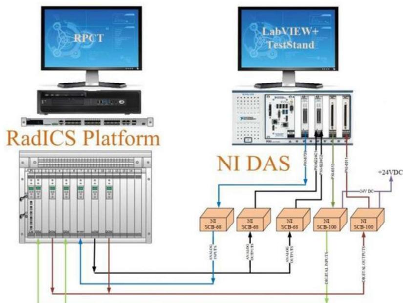
Рис. 3. Модифікований випробувальний стенд для автоматизованого тестування блоків AFBL
