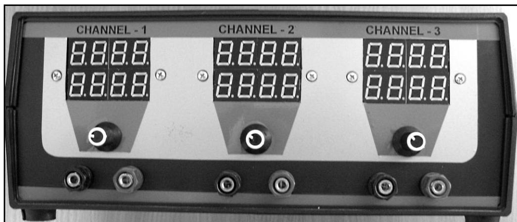
*Рисунок 7 – Зовнішній вигляд блока живлення*
