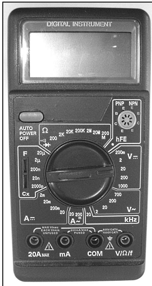
Рисунок 8 – Зовнішній вигляд мультиметра
