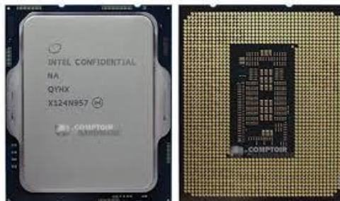
Рисунок 2.32 – Процесор Intel® Core™ i5-12400F
