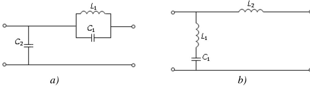
Fig. 2.14. Burst attenuation filter circuits
