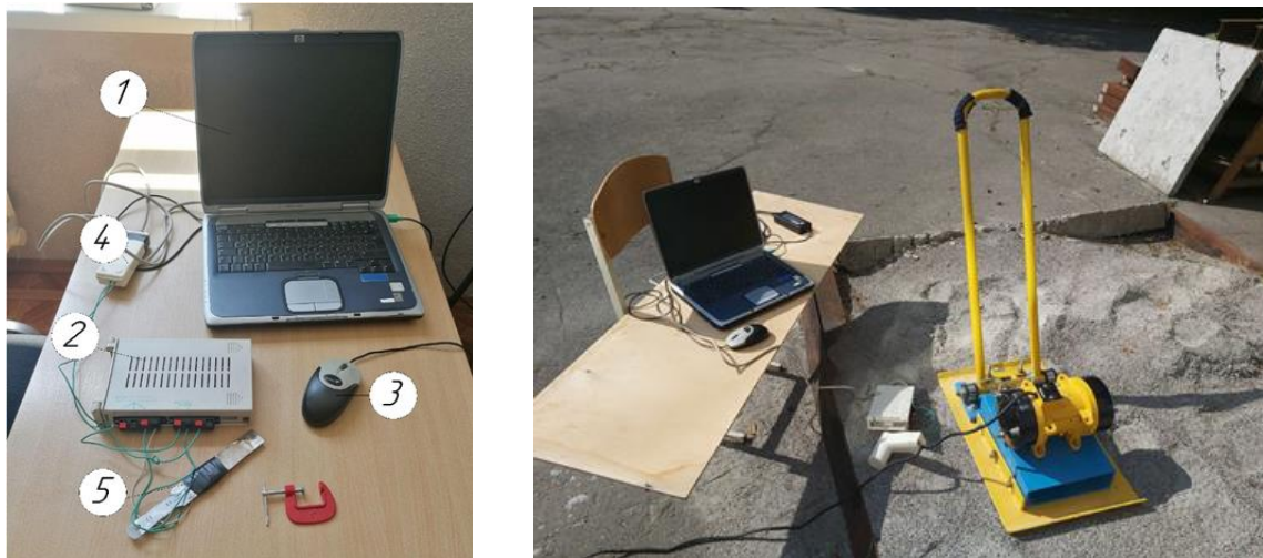
Рис. 2. Лабораторний приладно-вимірний комплекс: 1 – ПК, 2 – аналого-цифровий перетворювач, 3 – комп'ютерна мишка, 4 – COM-перехідник, 5 – тензобалка
