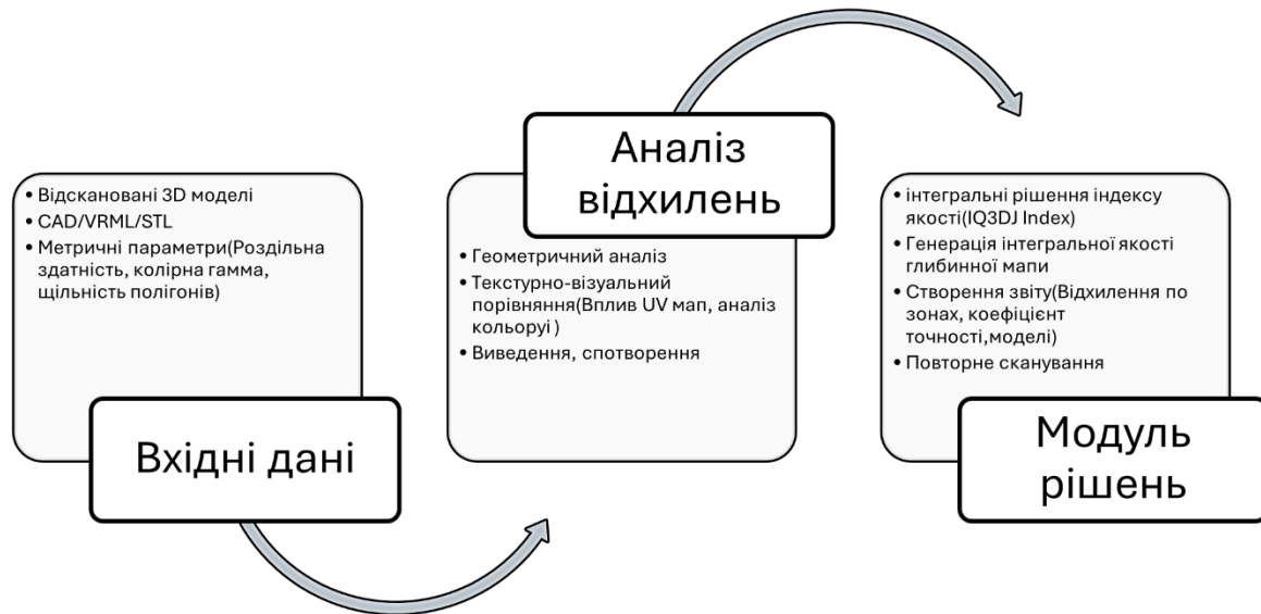
Рис. 1. Етапи обробки та аналізу в системі контролю якості 3D-моделей.
