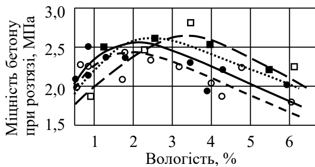
Рис. 2. Вплив вологості бетону на його міцність при розтязії.
