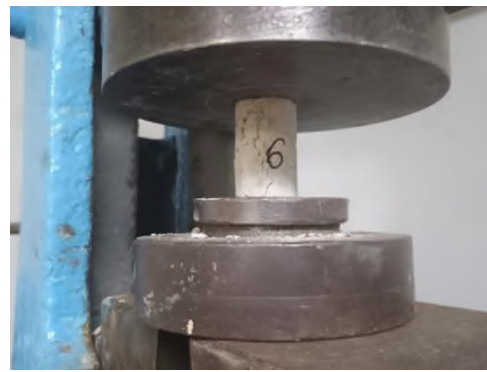
Рисунок 1 – Зразок ґрунтоцементу: 1 – до та 2 – після прикладання руйнівного навантаження.
