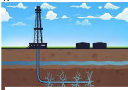
Рис.1 – Схема проведення БГРП в горизонтальній свердловині
