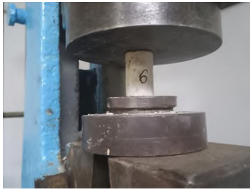
Рисунок 1 – Зразок ґрунтоцементу: 1 – до та 2 – після прикладання руйнівного навантаження.
