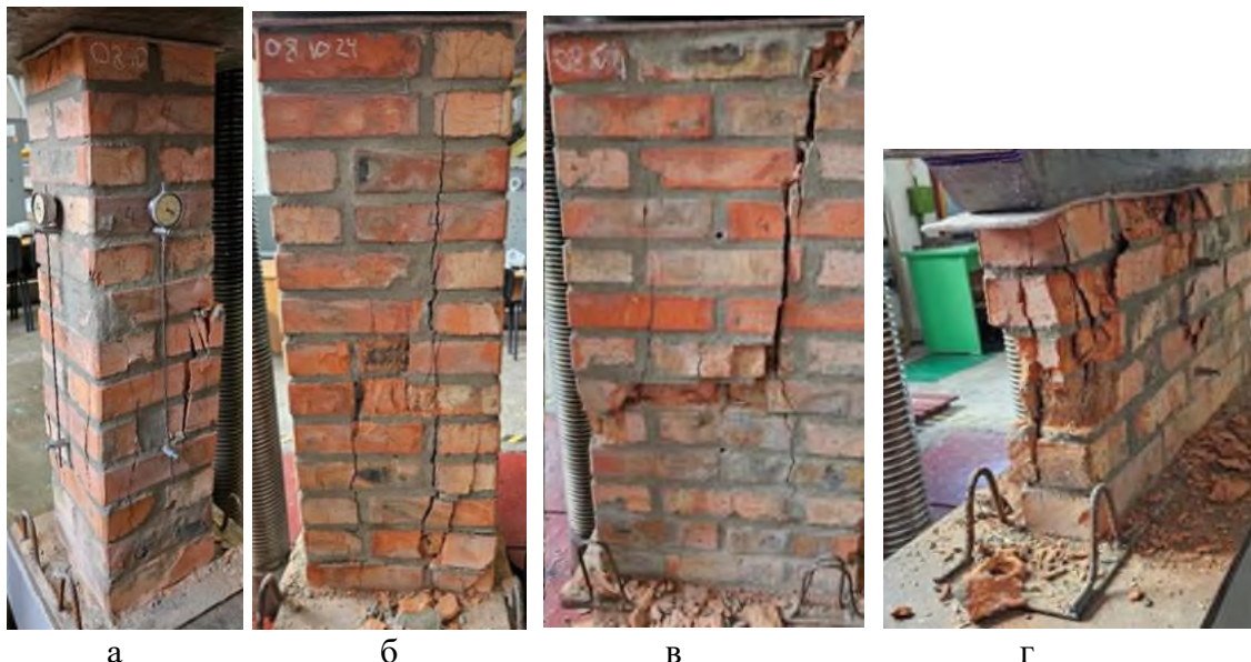
Рисунок 1 – Характер руйнування дослідних зразків: а – С-25.25.100; б – С-38.38.100; в – С-51.51.100; г – Ст-90.12.44
