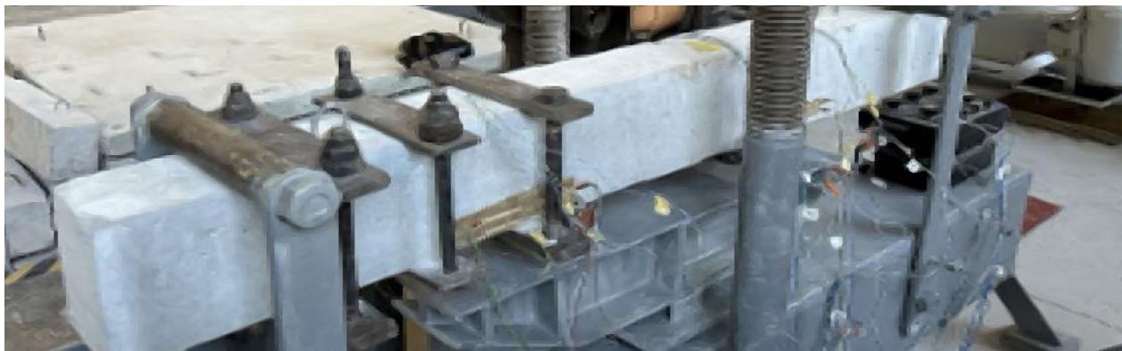
Рисунок 1 – Дослідна балка в силовій установці перед випробуванням
