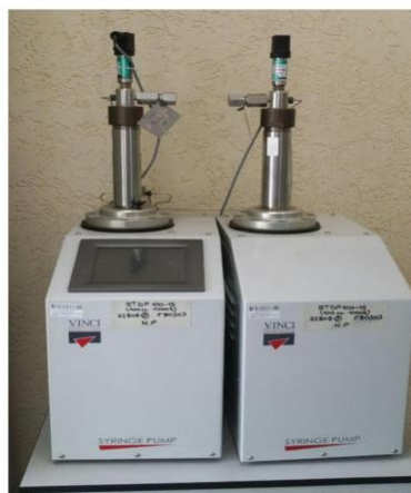
Рис. 2 Насос високого тиску для фільтраційних досліджень
