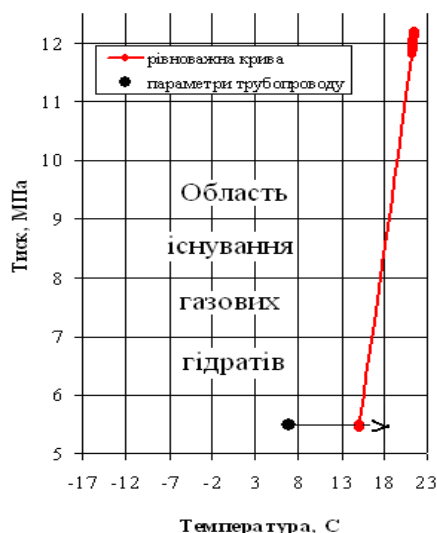
Рис. 1 Рівноважна крива гідратуутворення для природного газу ( CH_4 = 90,73\% , C_2H_6 = 5,31\% , C_3H_8 = 1,28\% , C_4H_{10} = 0,55\% , C_5 + вищі = 0,34\% , N_2 = 1,47\% , CO_2 = 0,32\% ) і параметри трубопроводу
