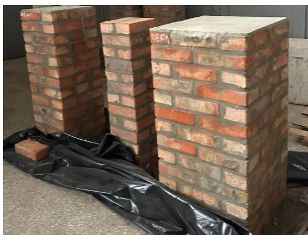
Рисунок 2 – Дослідні зразки для визначення міцності цегляної кладки на стиск
