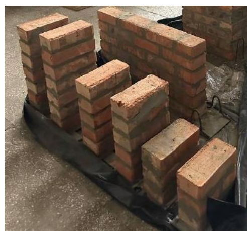
Рисунок 2 – Дослідні зразки для визначення міцності цегляної кладки на стиск
