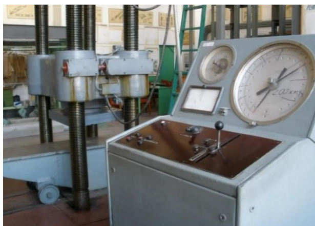
Рисунок 3 – Випробувальний прес ПГ-500
