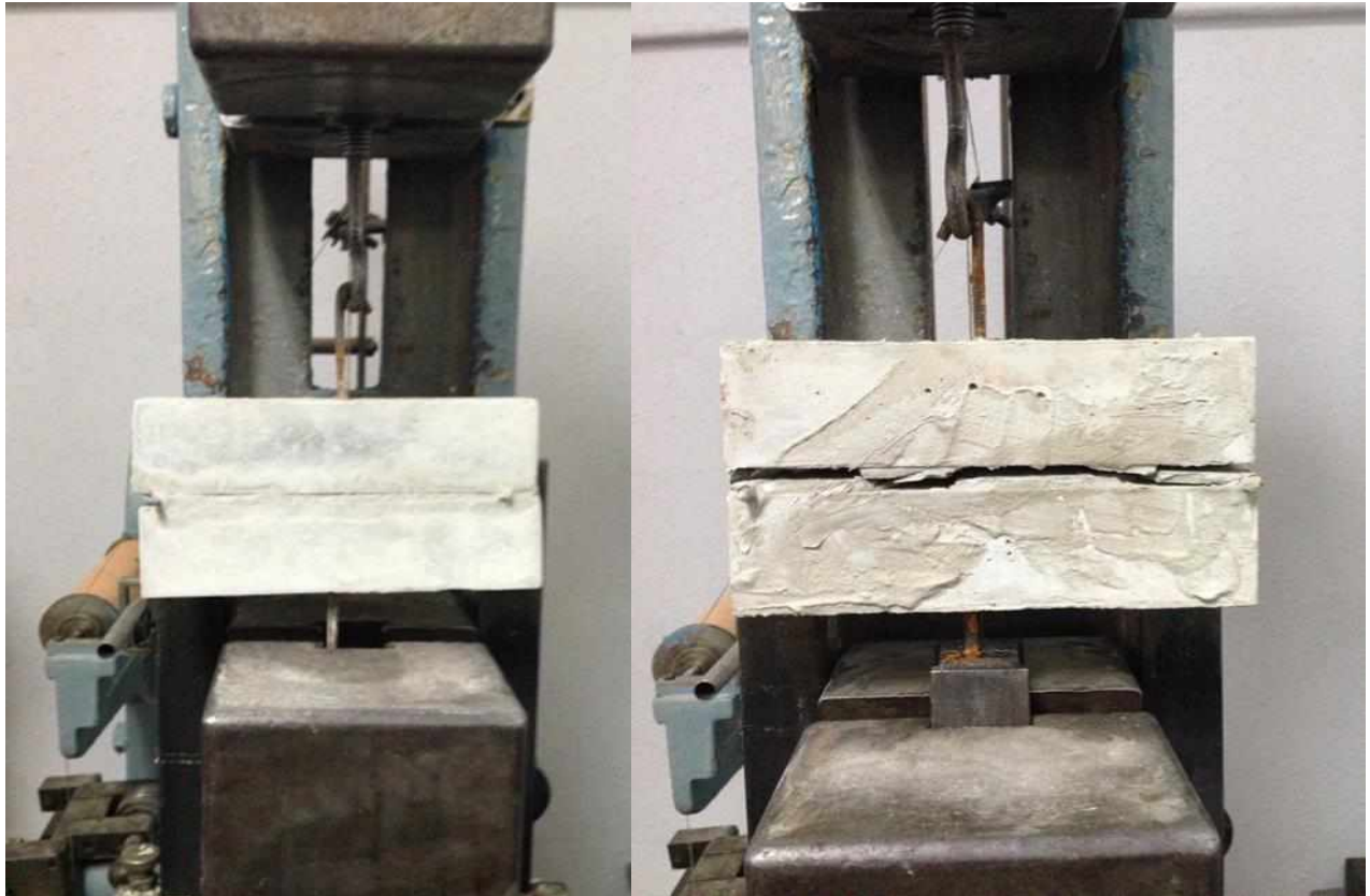
а) зразки до випробування на розрив, на пресі РП-5
