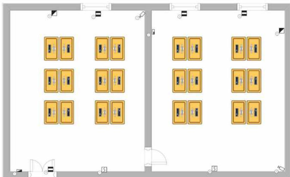
Рисунок 3.3. – План розташування обладнання комплексної системи кібербезпеки
