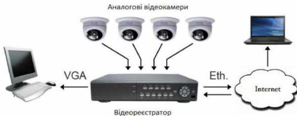
Рисунок 1.1 – Структурна схема аналогової системи відеоспостереження
