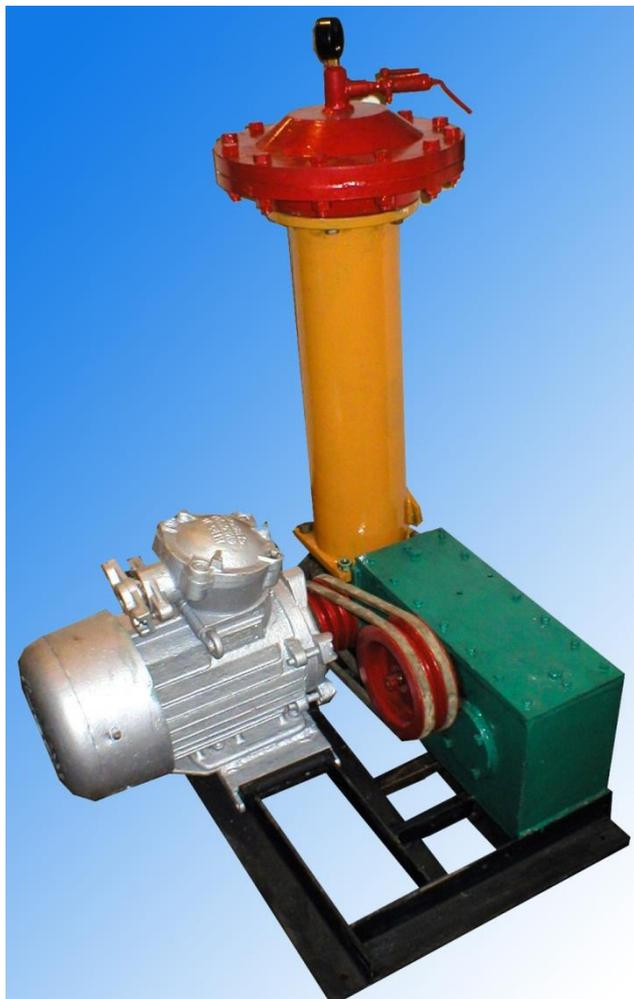
Однопоршневий розчинонасос РН 3,8 із комбінованим компенсатором пульсації тиску
