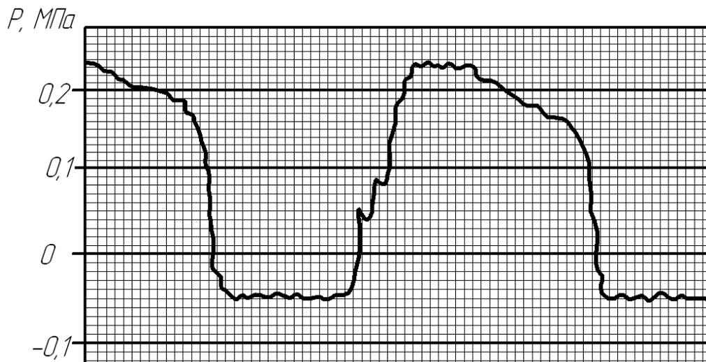
Рисунок 2 – Діаграма зміни тиску в усмоктувальній робочій камері розчинонасоса
