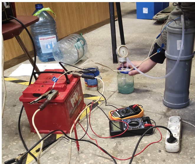
Рисунок 1 – Експериментальна установка для отримання водню шляхом електролізу
