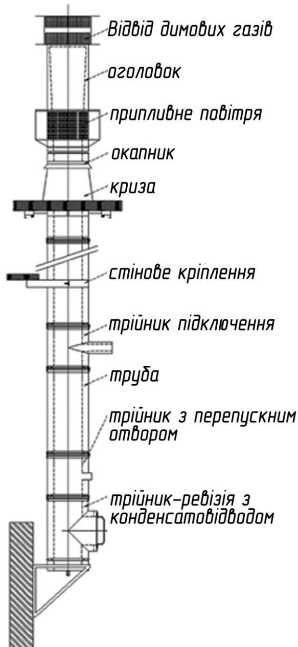
Рис. 6.1. Рекомендаційна схема монтажу коаксіального димоходу
