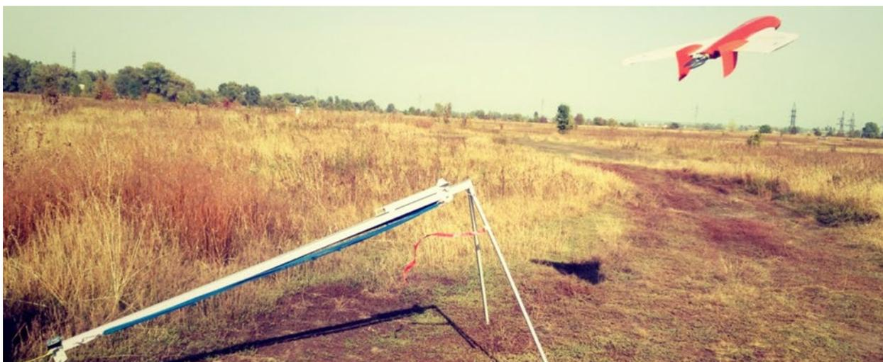
Рис. 1.7 Запуск БПЛА GeoScan 101
