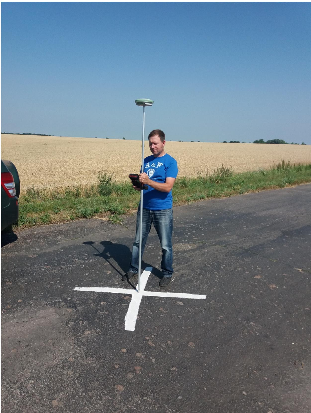
Рис. 2.2 Нанесення фарбою на тверде покриття розпізнавального знаку в вигляді хреста розміром 50×50 см.
