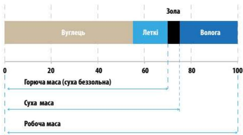
Рис. 1.2 Склад твердого палива
