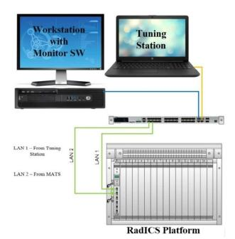
Рис. 1. Початкова конфігурація випробувального стенда для ручного тестування блоків AFBL
