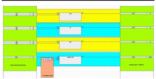
Рис. 2. Тестовий приклад для перевірки конфігурації блоків (AND, OR, XOR, SWITCH FP) з бібліотеки AFBL
