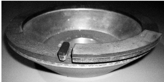
Рис. 1. Вигляд хонінгувального бруска в порівнянні з чашкою для алмазного шліфування
