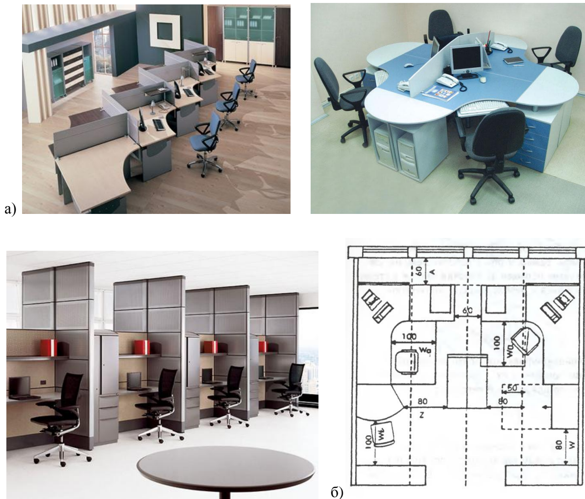
Рис. 5.11. Стандартне робоче місце в офісі: а) компонувальні схеми блокування робочих місць та ергономічні вимоги; б) ергономічні вимоги до робочого місця в офісі – рекомендації щодо обладнання сучасного робочого місця, розроблені компанією BENE: W_a – робоче місце 100 см не може перетинатись з проходами; W – 80 см; якщо цей простір не використовується як прохідний, сюди можуть відкриватись підвісні двері; Z – вхідна частина – 80 см; мінімум – 60 см; W_t – місце для відвідувачів – 100 см; A – доступ до технічних систем – 60 см, мінімум – 50 см
