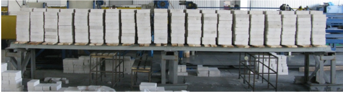
Рис. 1 – Випробування двопролітного нерозрізного профільованого сталевого листа
