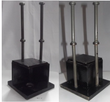
Рис. 2 Закладні деталі системи кріплення ЗБ колон з використанням гнучких анкерів технології зварювання «Nelson»
