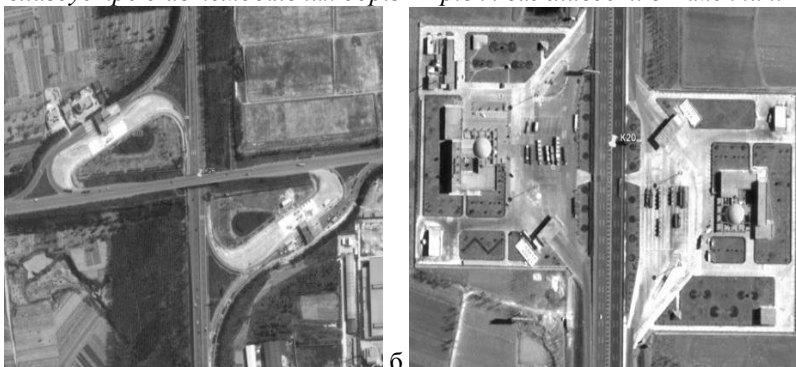
Рис. 7. Розміщення об'єктів сервісу вздовж автомагістралі Пекін-Харбін (G1), Китай, від перетину з S 50 до перетину G 102: а – двостороннє розміщення зі спорудженням дорожньої розв'язки; б – двостороннє розміщення в одному рівні з дорогою
