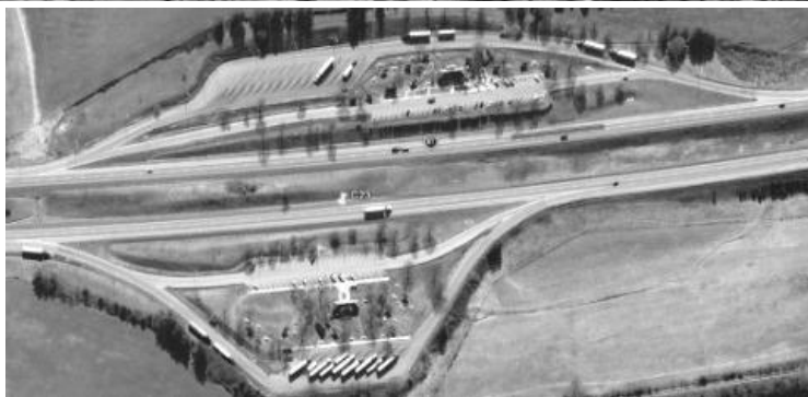
Рис. 3. Розміщення об'єктів сервісу вздовж U.S. Route 66, 81, США: а – двостороннє розміщення зі спорудженням дорожньої розв'язки; б – двостороннє розміщення в одному рівні з автомагістраллю
