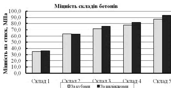
Рисунок 1 – Міцність складів бетонів визначена на зразках-кубах та циліндрах.
