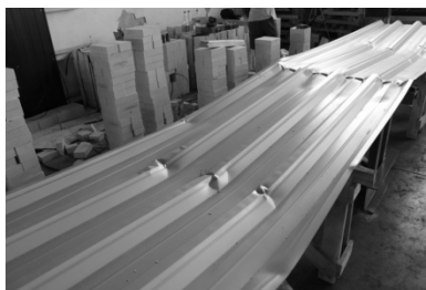
Рисунок 1. Загальний вигляд експериментальних зразків: а) серії 2P до випробування; б) серії 2N після випробування
