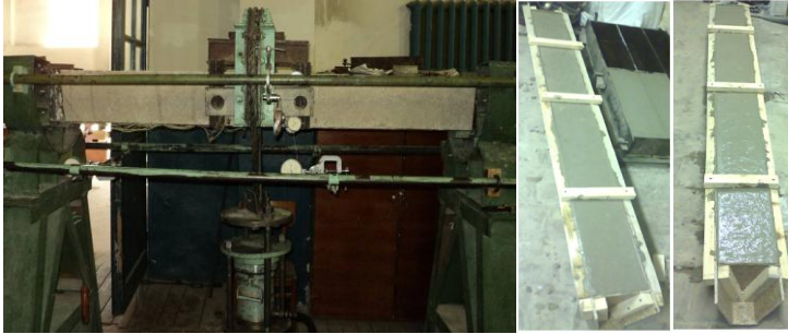
Рис. 2. Загальний вигляд установки для випробування та дослідні зразки після бетонування
