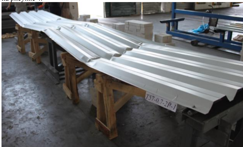
Рис. 4. Общий вид двух пролетного образца после разрушения
