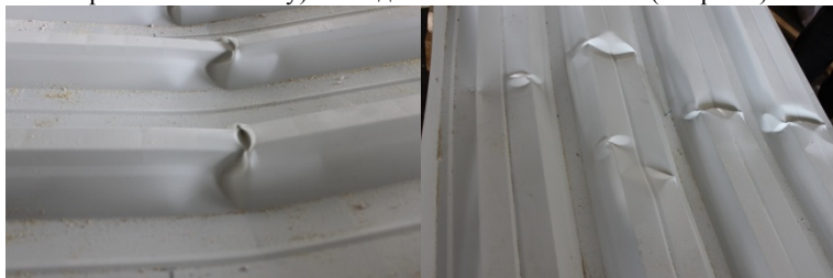
Рис. 2. Потеря устойчивости сжатых полок профлиста в положении негатив (слева) и позитив (справа)
