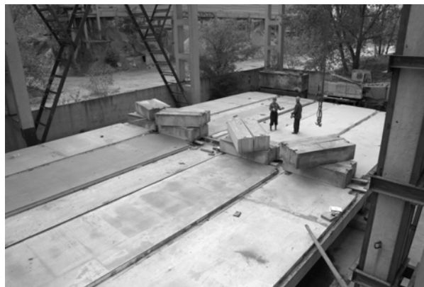
Рисунок 4 – Сталезалізобетонний ригель покриття Б1 під повним навантаженням
