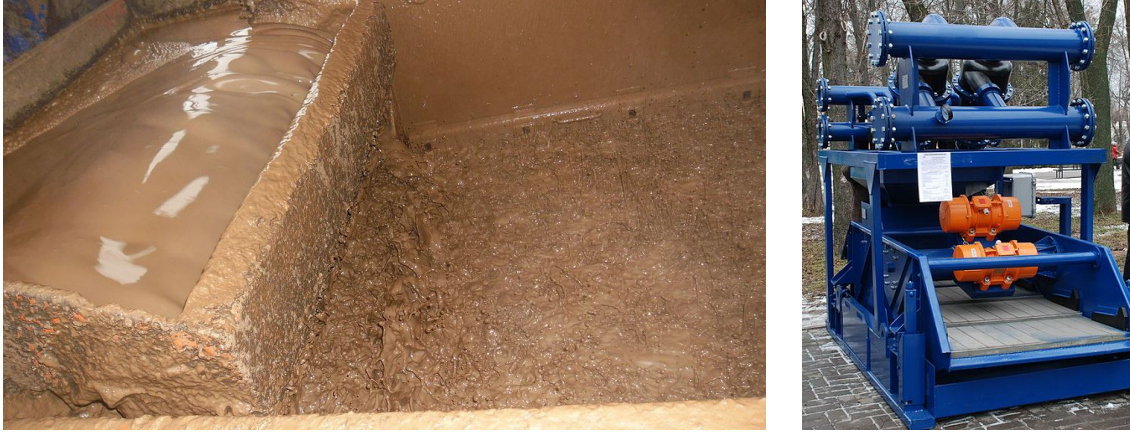
Рис. 8. Вібросита: ліворуч – буровий розчин на робочій поверхні вібросита (віброгрохота), гнідинцівське нафтогазоконденсатне родовище; праворуч – вібросито, виставка "Нафта і газ-2015"
