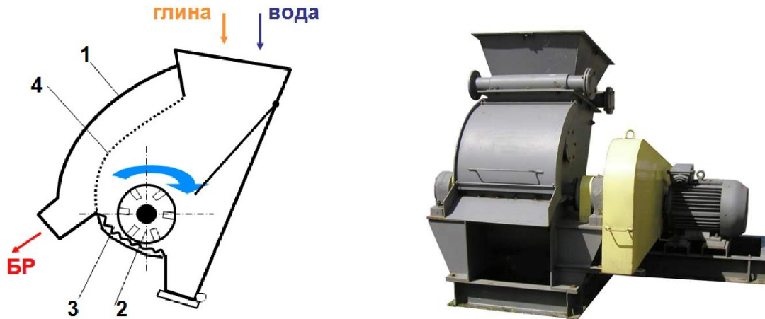
Рис. 4. Фрезерно-струменевий млин: 1 – бункер; 2 – ротор; 3 – диспергуюча рифлена плита; 4 – вихідна решітка
