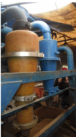
Рис. 9. Гідроциклони і батарея гідроциклонів для очищення бурового розчину: 1 – патрубок подачі вихідної пульпи; 2 – зливний патрубок; 3 – пісковий патрубок
