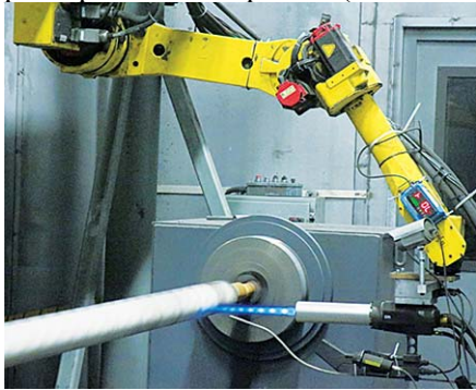
Рис. 3. Роботизированный комплекс для нанесения твердосплавного покрытия методом HVAF
