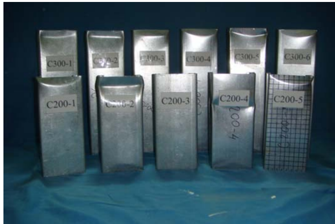
Рис. 4. Характер руйнування дослідних зразків
