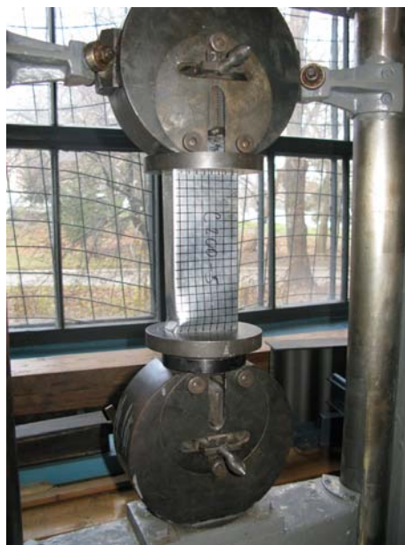
Рис. 2. Випробування на стиск коротких стійок С-подібних профілів
