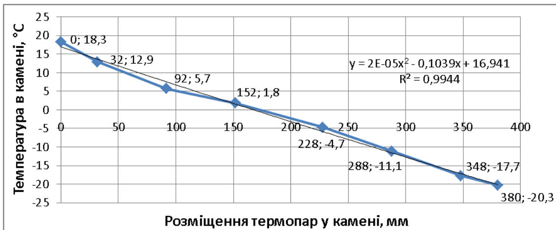
Рисунок 2 – Розподіл температури по товщині другого виду каменів керамічних: 0 мм, 32 мм, ..., 380 мм – відстані від лицьової грані виробу до місця розташування термопар; 18,3 °C, 12,9 °C, ..., -20,3 °C – температури в місцях розташування термопар.
