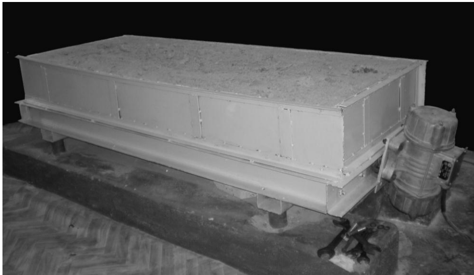
Рисунок 1 – Фізична модель віброформи з похилим вібробуджувачем
