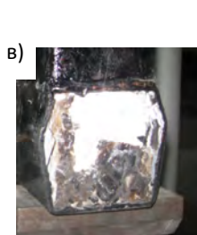
Рисунок 3 – Характер руйнування зразка серії ТБС-4: а) загальний вигляд зразка; б) крайній переріз верхнього пояса; в) опорний вузол; г), д) вузли з'єднання верхнього і нижнього поясів з опорним стояком
