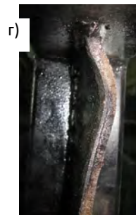
Рисунок 3 – Характер руйнування зразка серії ТБС-4: а) загальний вигляд зразка; б) крайній переріз верхнього пояса; в) опорний вузол; г), д) вузли з'єднання верхнього і нижнього поясів з опорним стояком
