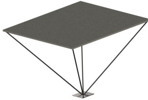
Рис. 2. Модуль структурно-вантової конструкції покриття
