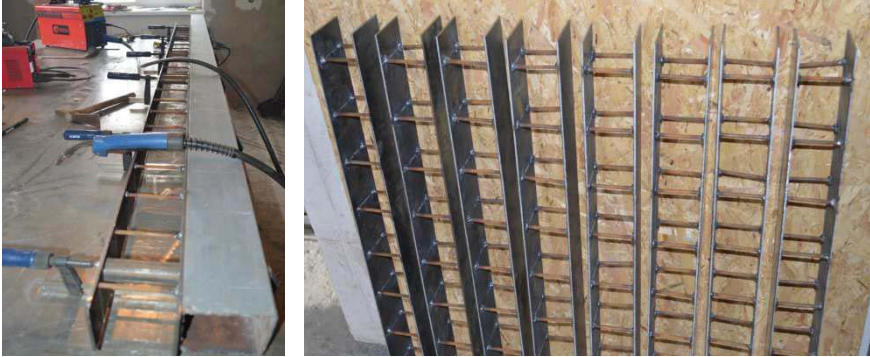
Рис. 1. Каркаси для сталезалізобетонних виробів з використанням листової арматури
