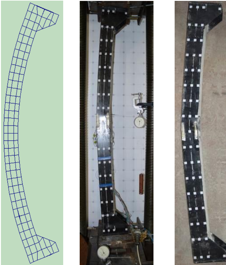
Рис. 2. Модель завантажена з ексцентриситетом 50 мм
