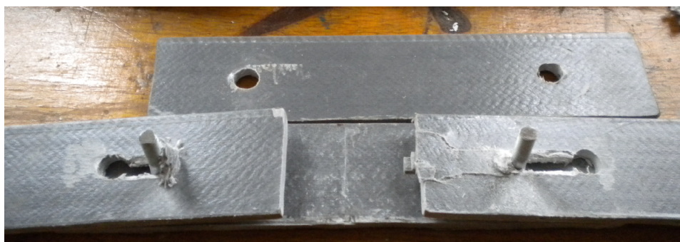
Рисунок 8 – Характер руйнування болтового з'єднання
