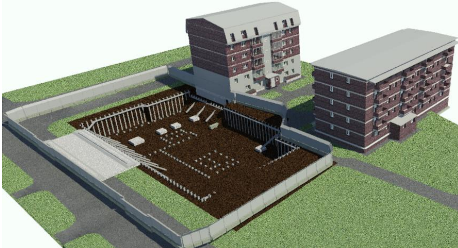
Рисунок 1 – Просторова модель ситуації влаштування котловану в існуючій забудові
