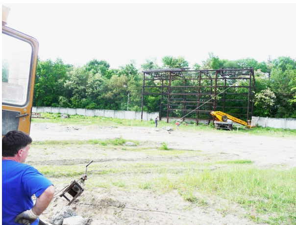
Рис. 3. Навантаження каркаса під час експерименту
