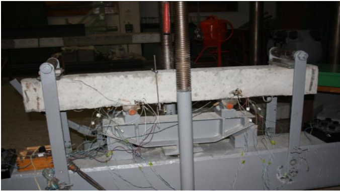
Рис. 3. Балка Б-ПМ-2-а у випробувальній установці
