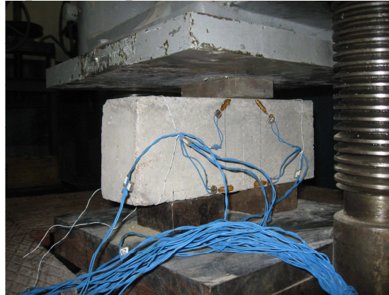
Рисунок 2 – Зразок С-2-0,65 під час випробування у пресі ПГ-125
