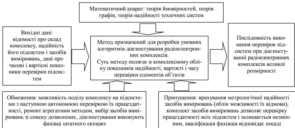
Рис. 1. Схема реалізації методу розробки алгоритмів діагностування радіоелектронних комплексів
