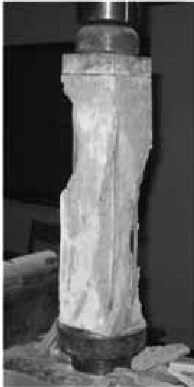
Рис.1. Исследование опытных образцов на центральное сжатие
