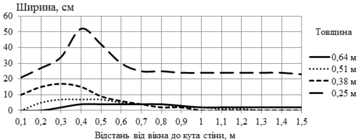
Рис. 2. Ширина ділянки внутрішньої поверхні стіни з температурою, меншою ніж 16 °С
