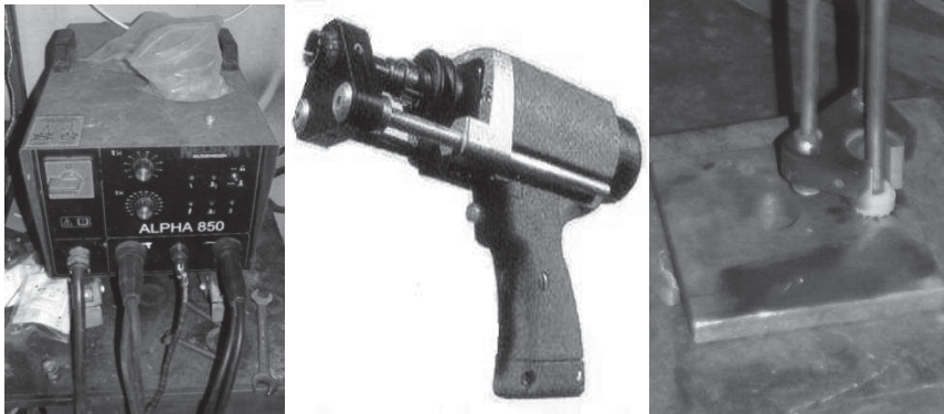
Рис. 3. Обладнання для зварювання витягнутою дугою «ALPHA 850» та процес приварювання гнучких анкерів.
